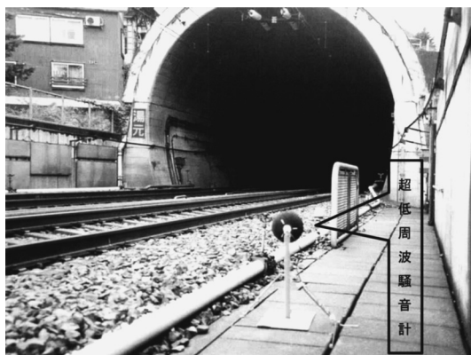
図-1 新幹線高速走行試験の際、トンネル坑口線路内に超低周波騒音計を設置してのトンネル微気圧波測定状況
