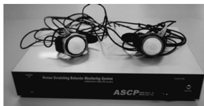
図-2 搔破行動量測定システム（試作）
