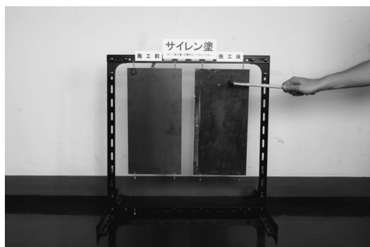
図-4 塗装による放射音低減工法
